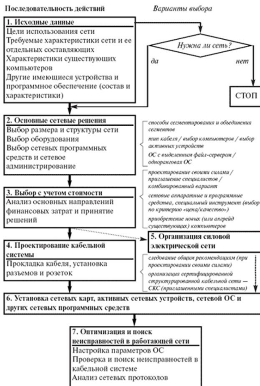
Рис. 1. Приблизительная последовательность действий при проектировании компьютерной сети
