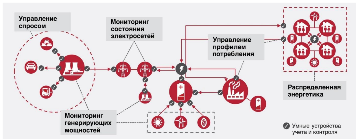
Рис. 8.2. Функционирование умной энергосистемы
