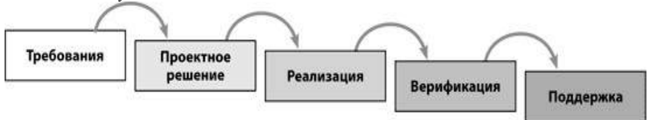
Рис. 1.2. Разработка продукта — каскадная модель
